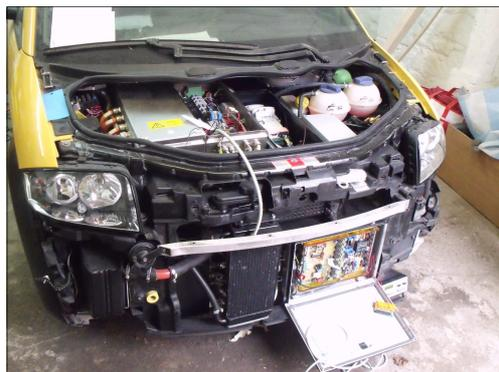
Neben dem neu eingebauten Elektromotor bieten die von der Firma Krebs & Aulich in Derenburg auf Elektroantrieb umgerüsteten Elektro-Audi A 2 reichlich neue Steuerungs- und Regelungstechnik unter der Haube
