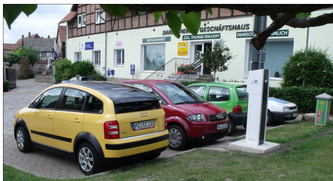
Vier E-Mobile an zwei Ladesäulen: Zwei im HEEMO-Projekt umgerüstete Elektro Audi in gelb und rot, ein grüner E-Twingo und der stadtbekannte E-Golf vor der neuen (weißen) „intelligenten“ HEEMO-Ladesäule für windabhängiges Laden und Rückspeisen
