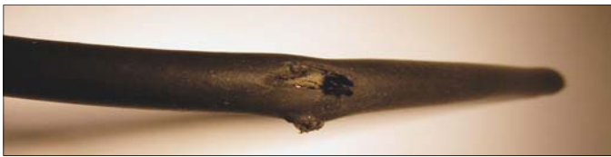
Das Opfer: Ein unschuldiges Stromkabel zwischen den Solarzellen auf dem Dach und dem Wechselrichter in der Schaltzentrale
