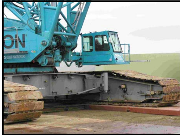
Ein riesiger Kran bewegt sich nur auf schweren Eisenstahlplatten langsam weiter
